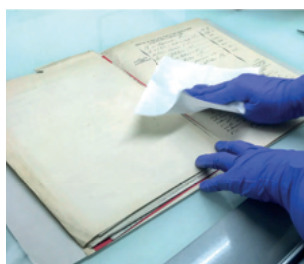
Essuyage d'un document à la lingette effectué sous sorbonne des Archives de France. ©INRS
