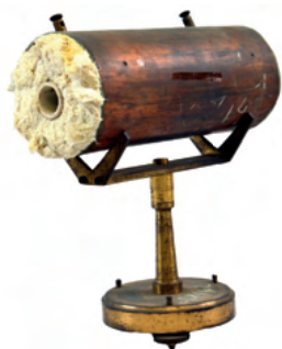
Pierre Chenevard, Four électrique cylindrique du dilatomètre différentiel enregistreur, 1916, 13x10,5x24 cm, Alliages cuivreux, Amiante, N° d'inventaire 20714-0001 © Musée des Arts et Métiers, Cnam/Denis Pruvrel
