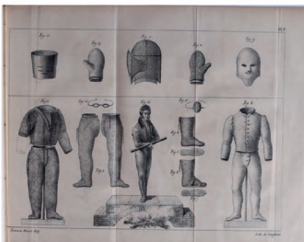
Planche présentant le costume en amiante pour pompiers du chevalier Aldini. © Wellcome Collection, Aldini, G. (1830). Art de se préserver de l'action de la flamme. Madame Huzard. p.147
