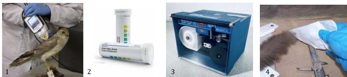
1. Prélèvements à l'aide de l'outil de détection XFR, sur un spécimen naturalisé. ©HE-Arc CR, M. Dangeon, 2014. 2. Bandelettes pour spots-tests – Test de Merckoquant. ©Humeau. 3. Détecteur de gaz toxique MDA Scientific TLD1. ©AnalyticalWarehouse 4. Prélèvements par lingette sur le socle d'un spécimen naturalisé. ©Marion de Beaulieu.
