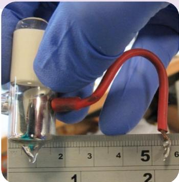
Dépose d'un interrupteur au mercure
