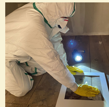
Méthode de prélèvement du plomb avec lingette
